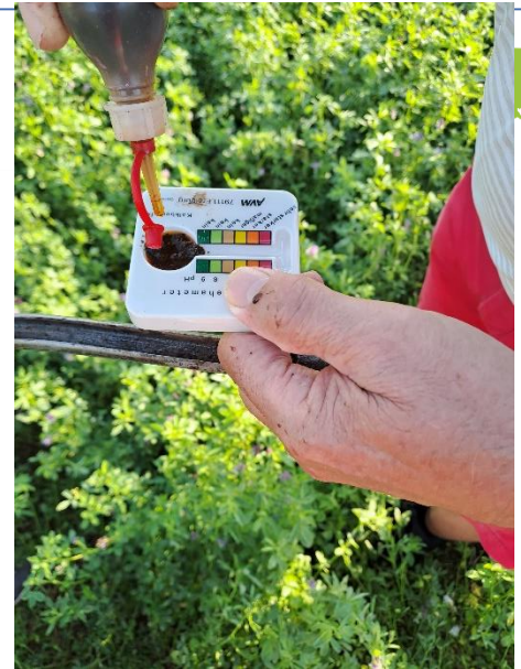
Abbildung 5: pH-Wert-Messung mit dem Hellige pH-Meter am Standort, Quelle Dr. B. Fährnich
